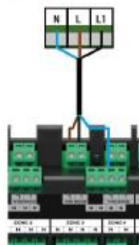
S'applique à la version 230 V: Figure 10: Raccordement électrique du thermostat RT05 avec le Boitier de raccordement WB01 D-8-230V
