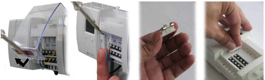
Figure 12 : Remplacement du fusible de protection
