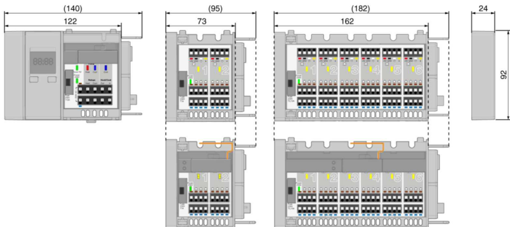
Figure 5 : Dimensions des composants de la gamme CosiTherm®
