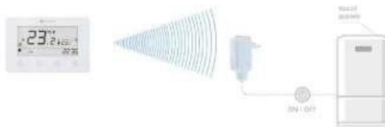
Figure 5 : Exemple de schéma d'application - Thermostat d'ambiance programmable RT05 F utilisé pour contrôler une chaudière à gaz.
