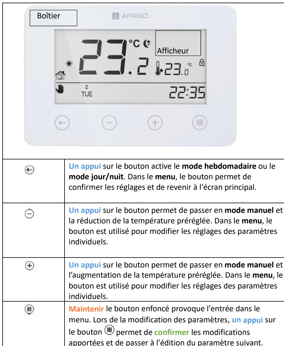
Figure 2 : Construction et description des boutons du thermostat RT05 F
